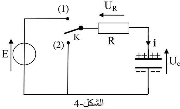
لغرض دراسة تطور التوتر الكهربائي بين طرفي مكثفة نركب الدارة الكهربائية الموضحة بالشكل-4 .
